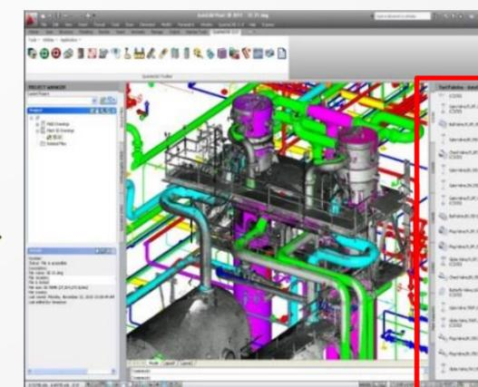
Die Rohrklassen werden zur Modellierung der Anlage benötigt und dienen als Grundlage für Materiallisten und Verwaltung bzw. für die Isometrierzeugung
