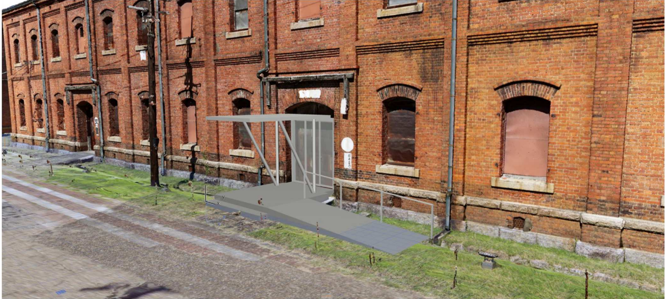
写真測量のデータ上で設計をしている様子 レンダリングした結果と同じなので、完成形を理解しやすい
