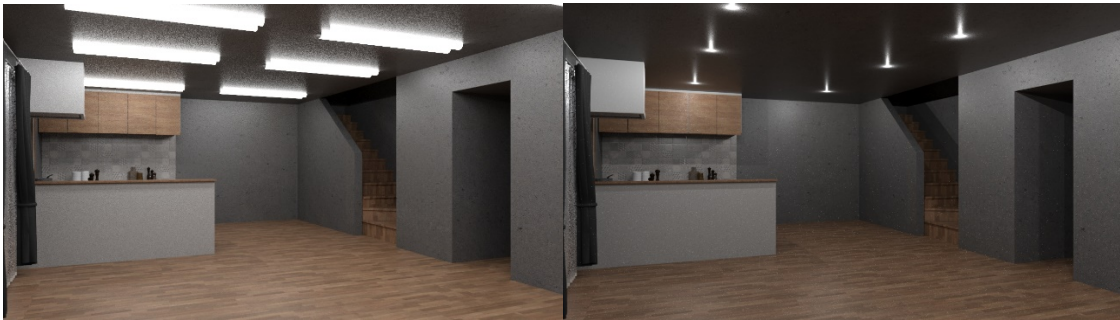
左: 蛍光灯のシミュレート(3500lm) 右: LED 電球のシミュレート(800lm)
