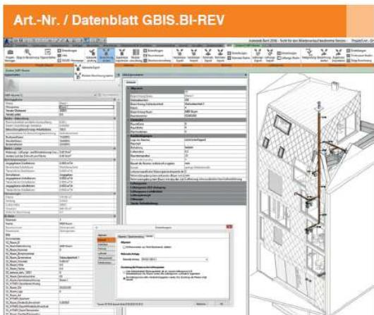
Tool zum intelligenten Verbinden von SOLAR-COMPUTER-Gebäude-Berechnungen mit Revit. Für die Berechnungen benötigte Raum-Daten, die im MEP-Raum noch nicht definiert sind, lassen sich als GBIS-Eigenschaften in Revit editieren und verwalten. Diverse Funktionen unterstützen effiziente BIM-Workflows, u. a. Bauteilverwaltung und Gebäudeprüfung. Heizlast-Berechnungen nach DIN EN 12831-1 lassen sich in Revit integrieren.
