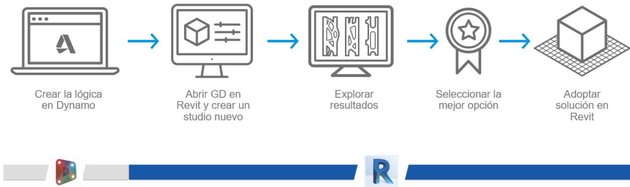
FIGURE 3 - ESQUEMA DEL FUNCIONAMIENTO DE GENERATIVE DESIGN EN REVIT
