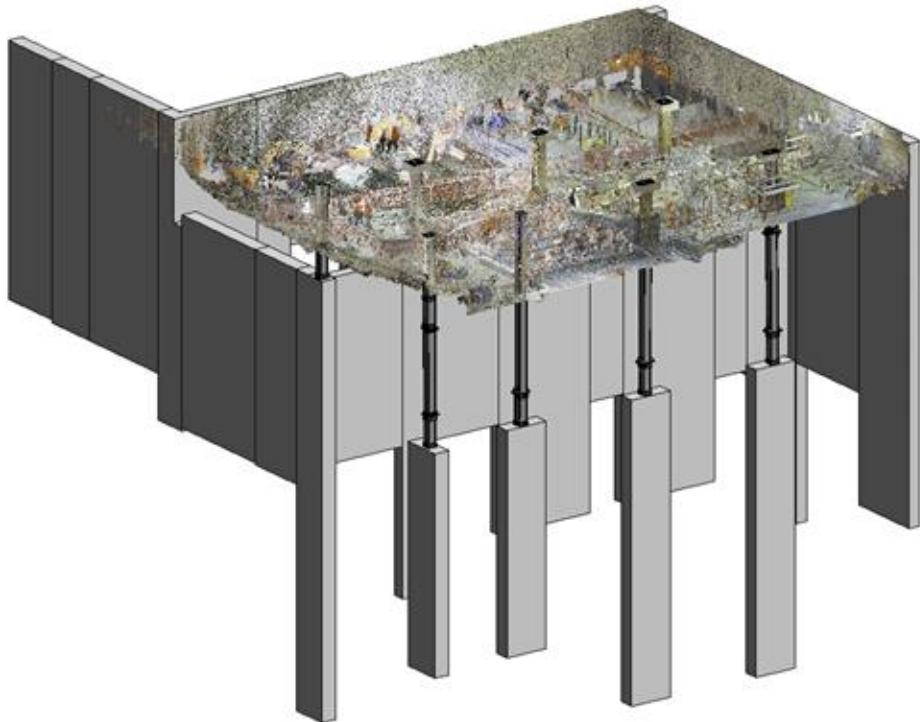
Une fois le modèle mis à jour, des plans as-built peuvent être produits pour mettre en évidence les différences de positions des poteaux préfondés.
