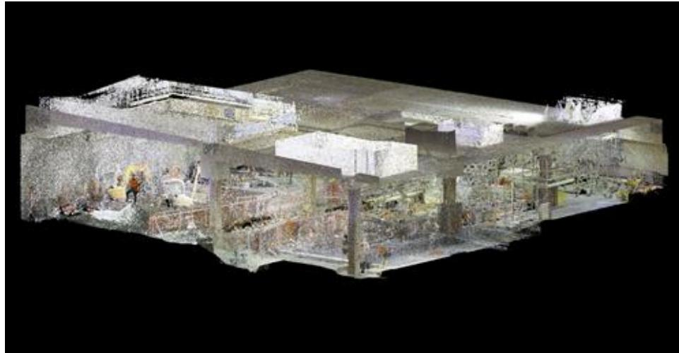
Le nuage de points est ensuite inséré dans le modèle Revit pour mettre à jour la position des poteaux préfondés.
