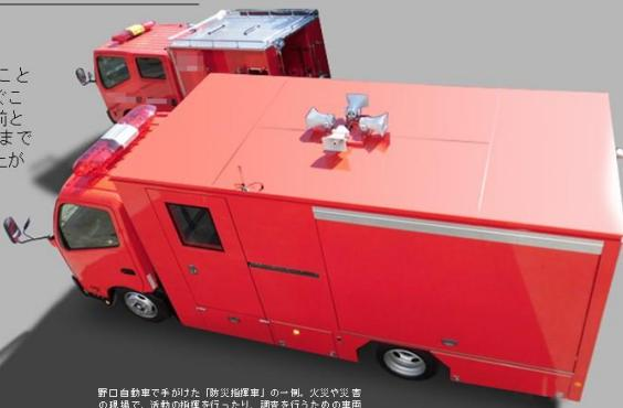
野口自動車で手がけた「防災指揮車」の一例。火災や災害の現場で、活動の指揮を行ったり、調査を行ったりの車両だ。この車両では、天井部分に防音器を設置。
