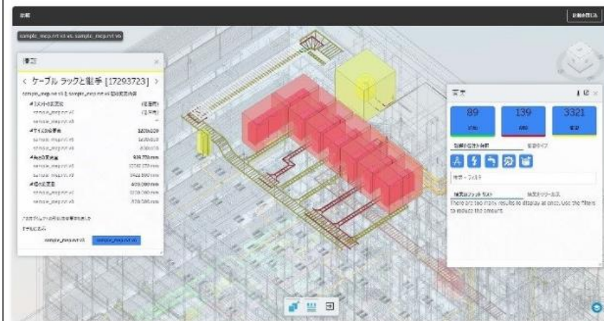
BIM 360ではRevitデータをバージョン管理し、新旧バージョン間でBIMモデルを比較できる
