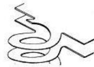
(d) 曲线整圆坡道(螺旋形)
