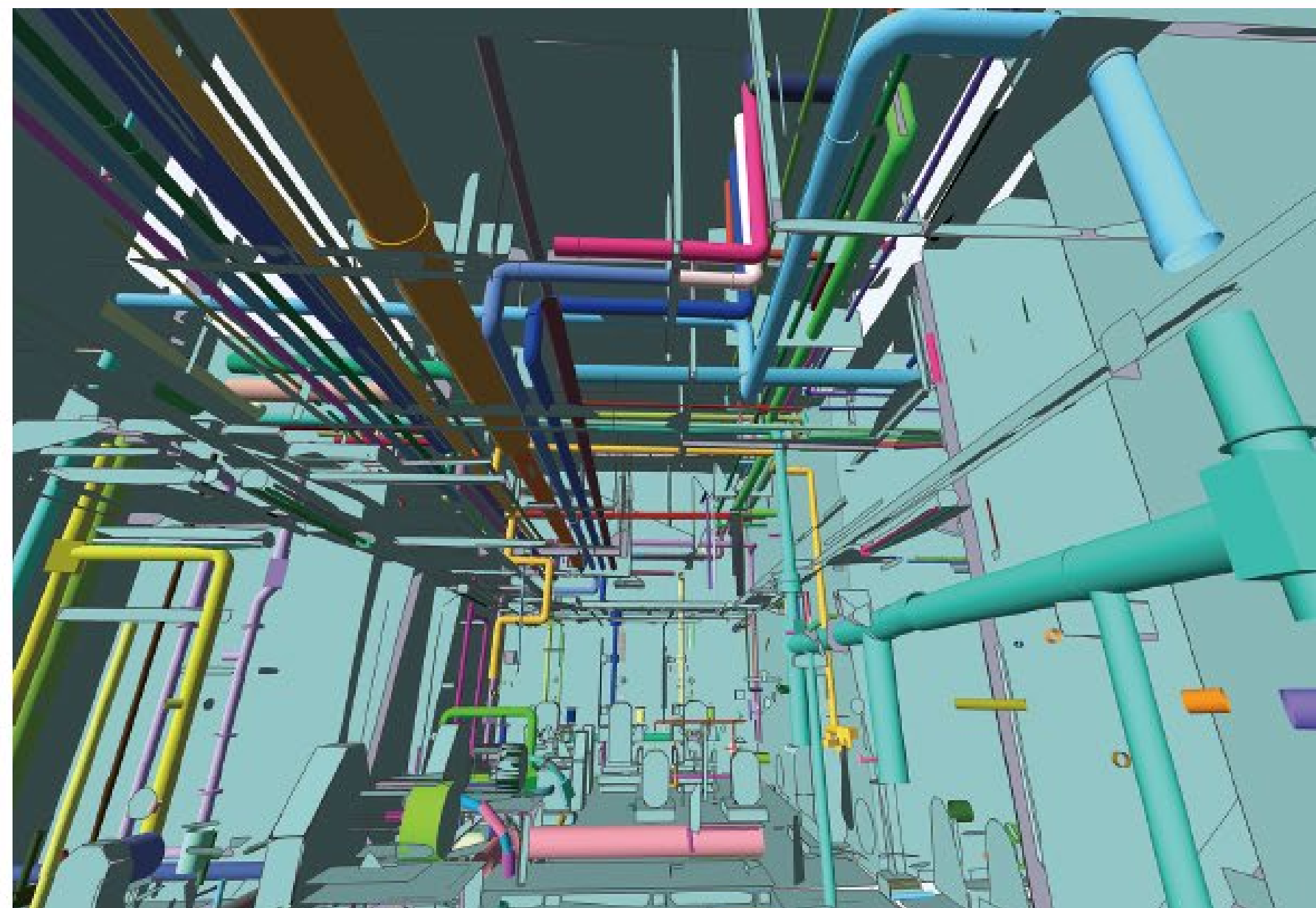
点群処理ソフト「infipoints」の 自動モデル化機能で作成した3Dモデル
