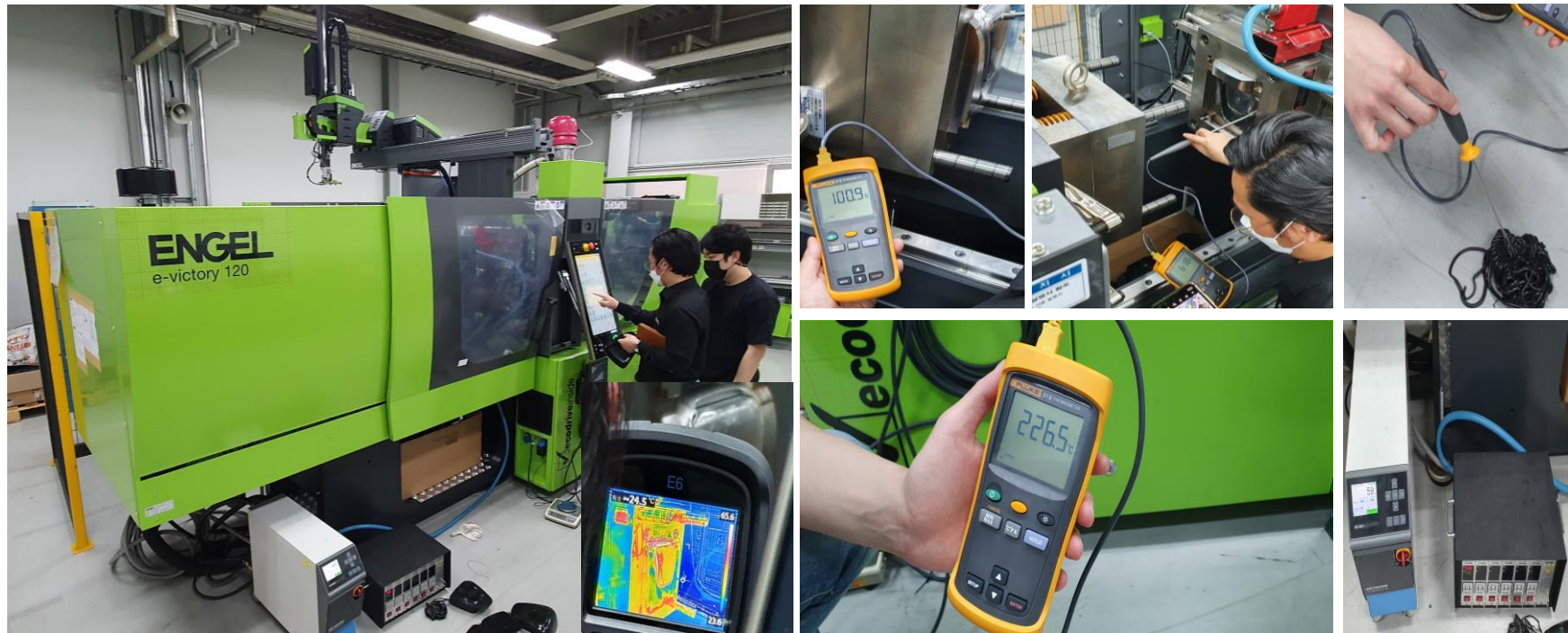
[그림] Airbag Cover 제품의 시험 사출(Trial) 현장
